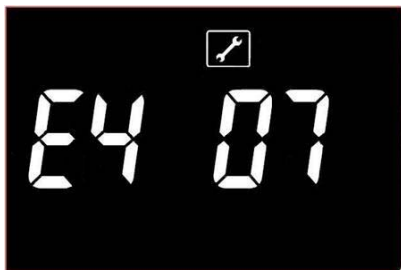
<Неисправность датчика температуры на выходе ГВС: индикация в течение 15 секунд>
