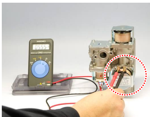
<замер сопротивления 1-го соленоидного крана>
