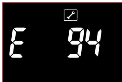
<Неисправность датчика температуры термостата>
