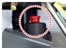
<Крышка вентиляционного хода закрыта>
